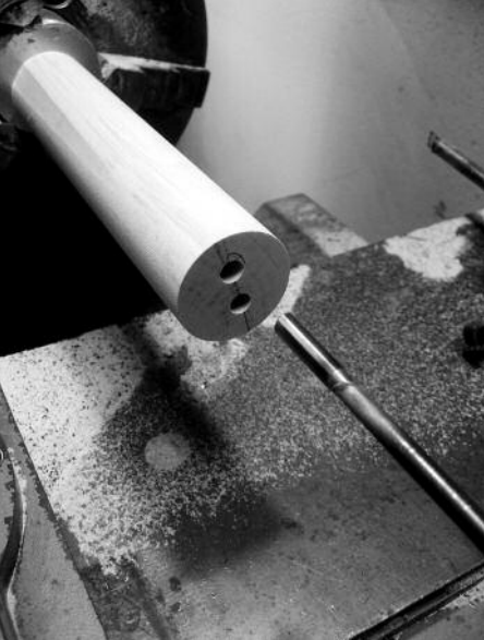
perçage cylindrique: les copeaux sont réduits en miettes... ci-dessous: fraisage à l'horizontale du pihet de la boha photo R. Matta
